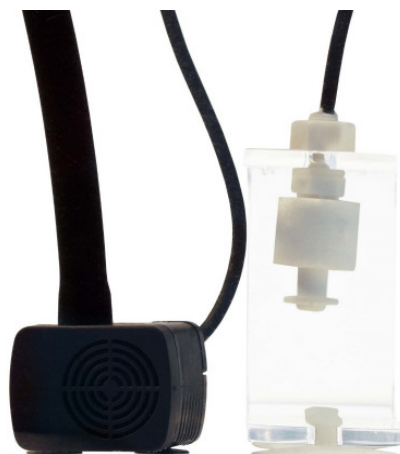
Рис. 3: Помпа для поддержания уровня с защитой от сухого старта. Крепится при помощи присосок на дне резервуара для воды.
