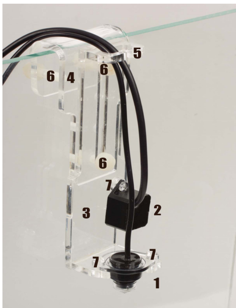
Рис. 6: Монтаж сенсоров №1 и №2 с помощью поставляемого держателя.
