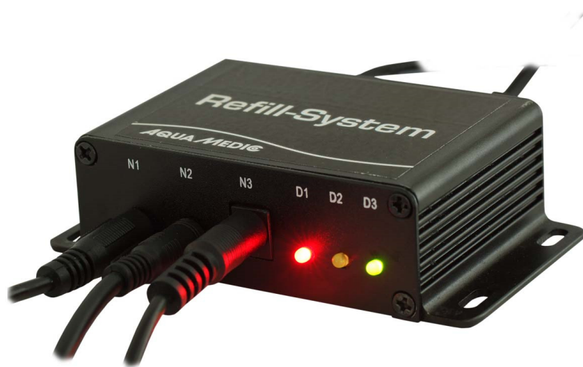
Fig. 1: Caja de control con los sensores N1 a N3 conectados
